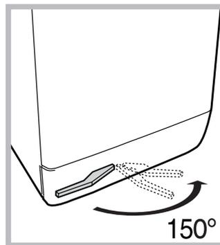
Ваша стиральная машина может быть оснащена специальными убирающимися колесами для облегчения ее перемещения. Чтобы опустить колеса и передвинуть оборудование, просто потяните за рычаг, расположенный слева под основанием машины. После установки
