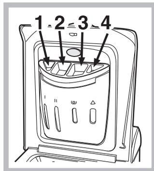
Для осуществления только отбеливания поместите отбеливатель в дополнительный дозатор 4 и задайте программу «Полоскание» и включите функцию «Отбеливание». Для отбеливания в процессе стирки засыпьте стиральный порошок и добавки, задайте нужную программу и включите функцию «Отбеливание».
